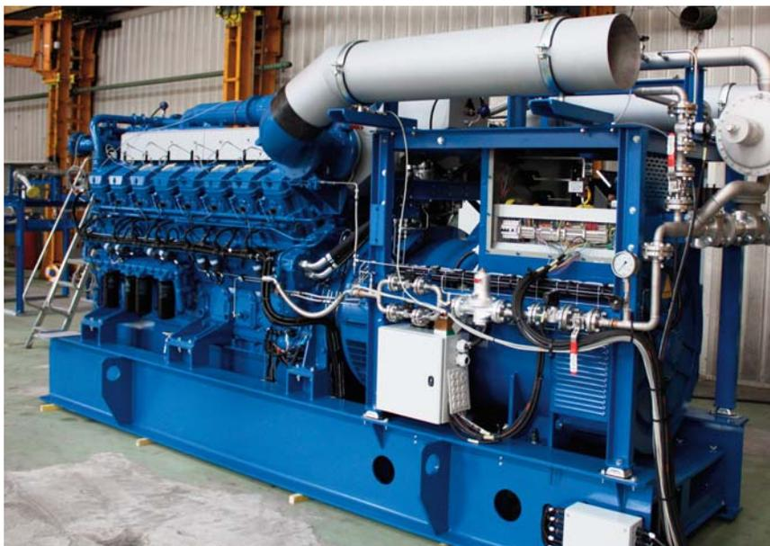
Газопоршневой энергоблок на базе двигателя Mitsubishi GS16R2 PTK
